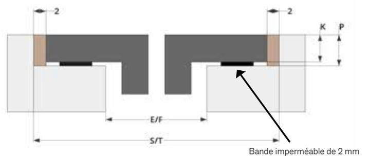
(2) Pour assurer une ventilation et une évacuation optimales de la chaleur de l'appareil, un espace d'air doit être aménagé entre le plan de travail et le tiroir.
