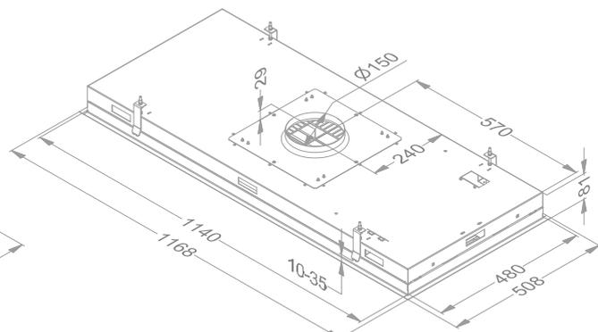
(1) La hotte doit être connectée avec le moteur dissocié extérieur 445.999 ou un moteur extérieur pour toiture plate (voir accessoires). Le débit d'air et le niveau sonore dépendent de l'installation.
