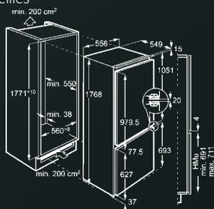
Système de fixation par : Pantographe
