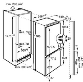
Système de fixation par : Pantographe
