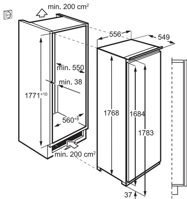
Système de fixation par : Pantographe
