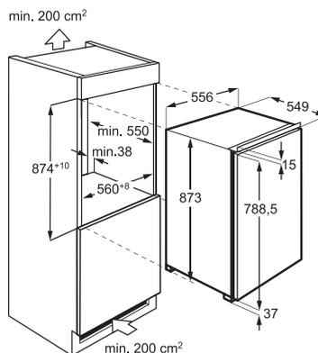
Système de fixation par : Pantographe
